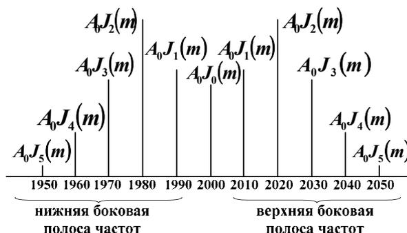
Рис. 2.7. Спектральная диаграмма сигналов с однотоновой угловой модуляцией при  $m=3$
