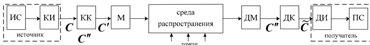
Рис. 5.1. Структурная схема системы электрической связи
